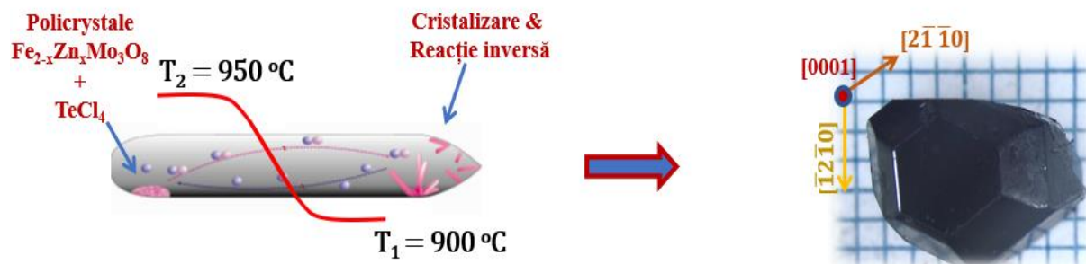
Figura 1 . Procesul tehnologic de creștere a monocristalelor de tip \text{Fe}_{2-x}\text{Zn}_x\text{Mo}_3\text{O}_8 cu substituții variabile 0 \leq x \leq 2 . Partea stângă demonstrează procesul experimental cu schițarea încărcăturii ampulei de cuarț. Partea dreaptă prezintă imaginea optică a unui monocristal de \text{Fe}_2\text{Mo}_3\text{O}_8 obținut prin metoda reacțiilor chimice de transport. Axele de coordonate reprezintă planul ab (2-1-10, -12-10) și axa c (0001) pentru structura hexagonală cu simetria P6_3mc .
