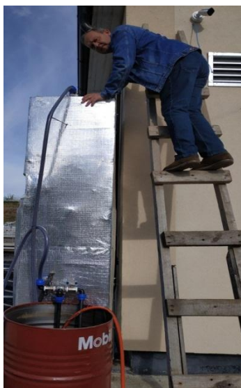
Fig. 1.4. Instalația pilot pentru separarea solidelor organice prin flotare.
