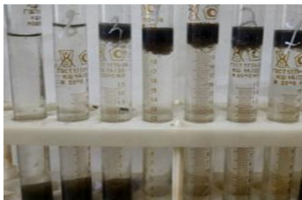
Fig. 1.3. Procesul de flotare cu ACC-1.
