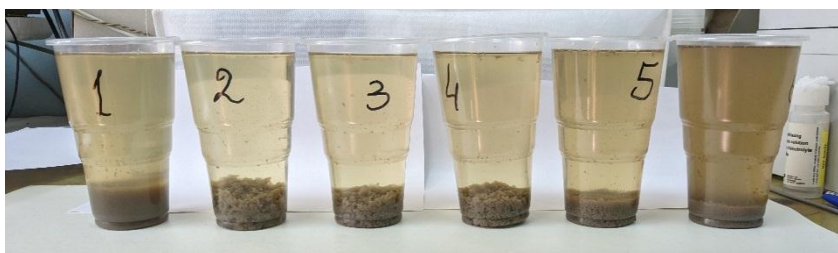
Fig. 1.10. Teste de floculare și flotare au fost realizate cu apa uzată provenită de la procesarea cărnii de pui „Floreni”.
