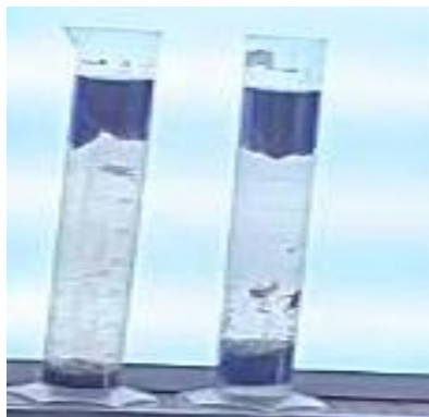
Fig. 1.2. Separarea prin flotare a nămolului activ cu anumită vechime (păstrat în sedimentatoarele secundare circa 60 zile) în decurs de 45 minute.
