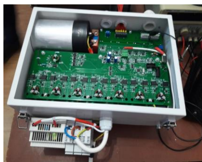
Fig.5.3.1 Vederea generală și schema circuitului de control al convertorului hexafazat elaborat
