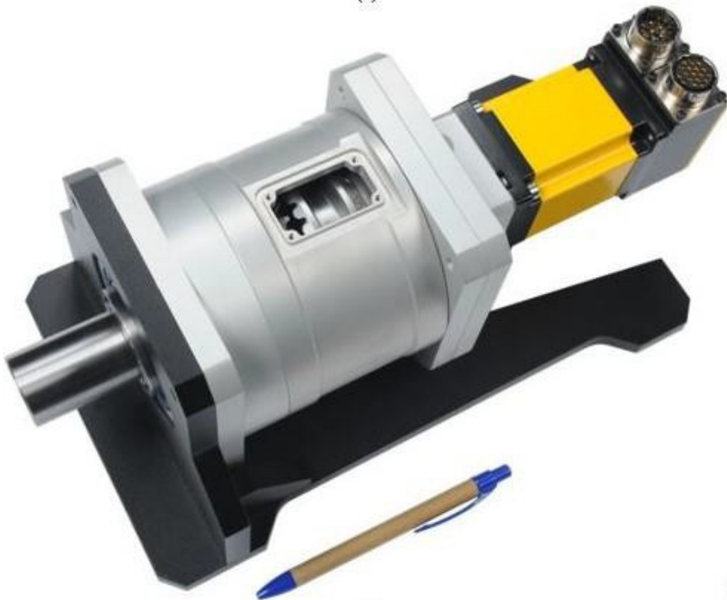
Figura 15. Mostre experimentale ale servo-motoreductoarelor precesionale de mică putere ( d_m=80 \text{ mm} ) cu angrenări A_{CX-CV}^{D,\beta} convex-concave cu dinți curbilinii (în arc de cerc) și roată-satelit montată axial flotant pe arborele-manivelă cu axe concurente în centrul de precesie ( i=-164 ) (a) și cu roți centrale interschimbabile cu locul cu rapoarte de transmitere i=-124/i=+125 (b)
