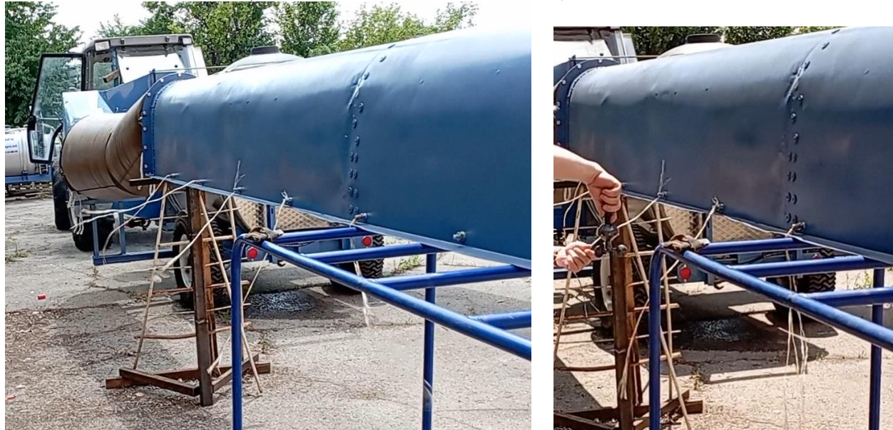
Fig.5.3.2. Efectuarea experimentelor de cercetare a eficienței perdelei de aer comprimat
