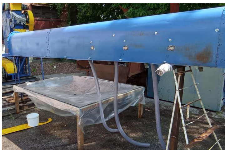
Fig.5.3.4. Tablierul de captare a picăturilor
