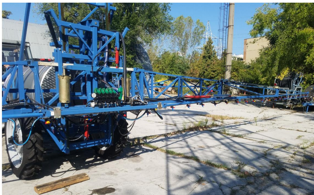
Fig. 5.2.4 Încercări ale mașinii STRA-21-2000C cu imitarea neregularităților de teren
