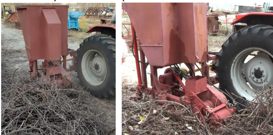
Figura. 5.7.2. Încercările tocătorului pentru tocarea coardelor viței-de-vie din grămezi pe teritoriul centrului experimental ÎS.ITA. "Mecagro".
