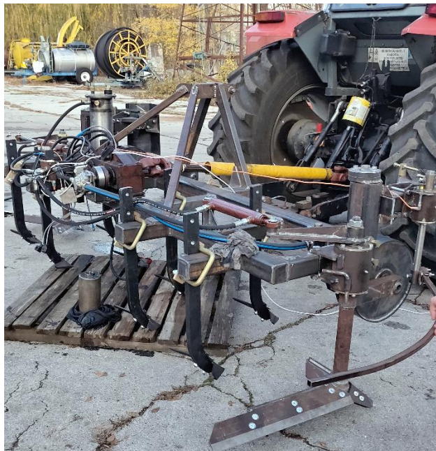
Figura. 4.12.2. Vederea generală a cultivatorului pentru lucrarea solului în
