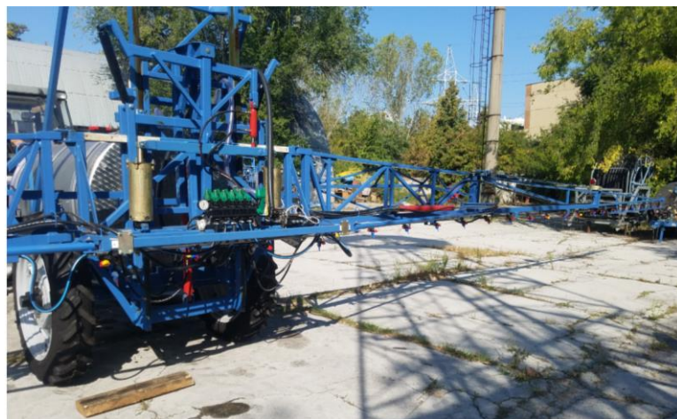
Fig. 4.7.5 Încercări ale mașinii STRA-21-2000C cu imitarea neregularităților de teren
