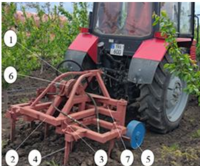
Figura 4.11.3 Vederea generală a scarificatorului în timpul cercetărilor.
