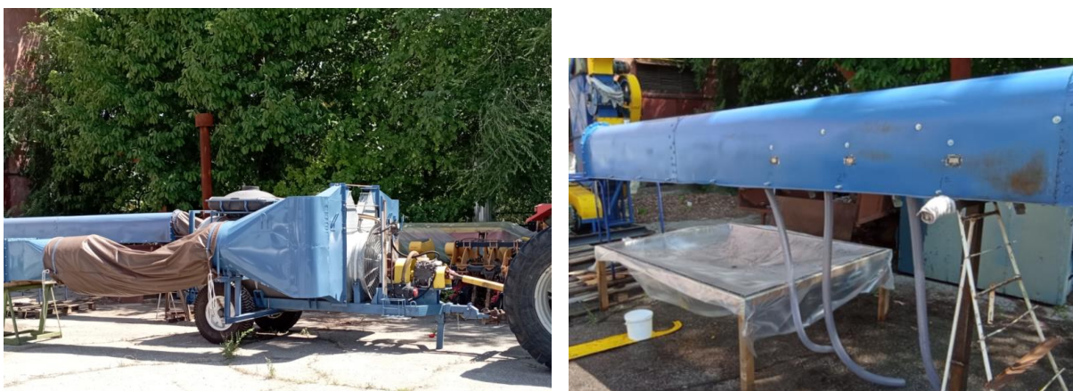
Fig.4.8.2. Instalația experimentală pentru imitarea procesului tehnologic de stropire în condițiile protecției pneumatice a jetului pulverizat (vedere dintr-o parte)
