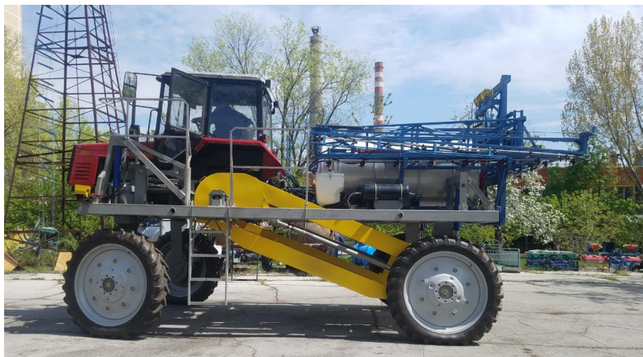
Fig. 5.1.1. Mașină de stropit autopropulsată MSA-1700-S
