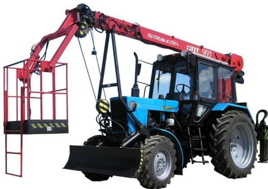
Fig.5.6.5. Macara-manipulator OPT-9195 cu instalare permanentă pe tractor Capacitate maximă declarată 2250 kg Preț 415000 lei
