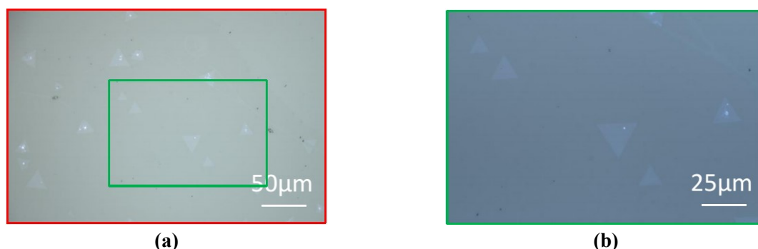
Figure. 6. Microfotografiile de filme ultrasubțiri obținute prin metoda CVD transferate pe substrat de Si/SiO 2 : (b) – reprezintă imaginea marită a ariei evidențiate cu verde pe foto (a)
