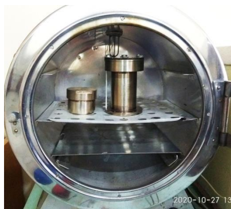
Fig.3. Autoclav pentru sinteză solvatermică a nanoparticulelor Fe3O4 dopat
