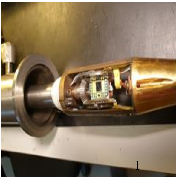
1) Держатель для низкотемпературных измерений с помещенным в нем спиновым вентиляем S/F/S
