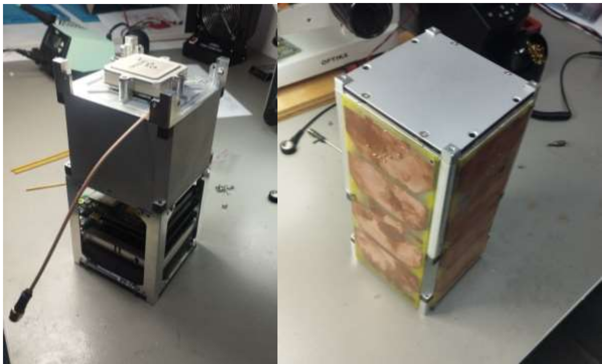
Fig. 2. Prototipul nanosatelitului TUMnanSAT-2U:
