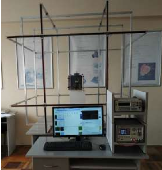
Fig. 1. Sistemul de simulare a câmpului geomagnetic pentru verificarea atitudinii nanosateliților.
