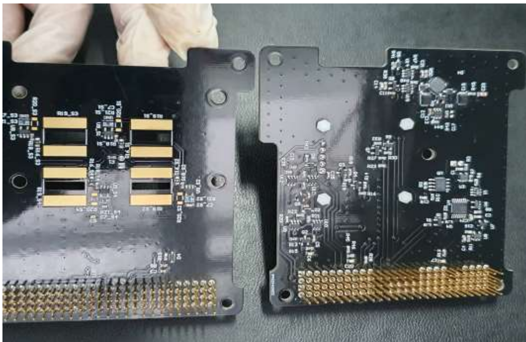
Fig. 2. a) Caracteristicile nonosenzorilor pe suport de ceramică; b) modulul de sarcină utilă cu senzori pe suport de ceramică.
