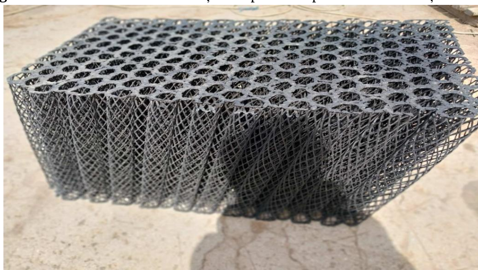
Figura 2. Segment de configurații cu suprafață specifică ramificată dezvoltată 150 m 2 /m 3
